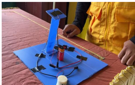
Gambar 2. Alat Pendeteksi Gempa Sederhana
