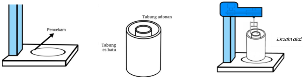
Gambar 3. Bagian pencekam tabung, tabung adonan dan es batu, serta desain alat secara keseluruhan.
