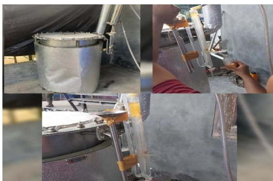
Gambar 4. Teknologi penyulingan minyak serai dapur di Kelurahan Mugirejo, Kota Samarinda, Kalimantan Timur
