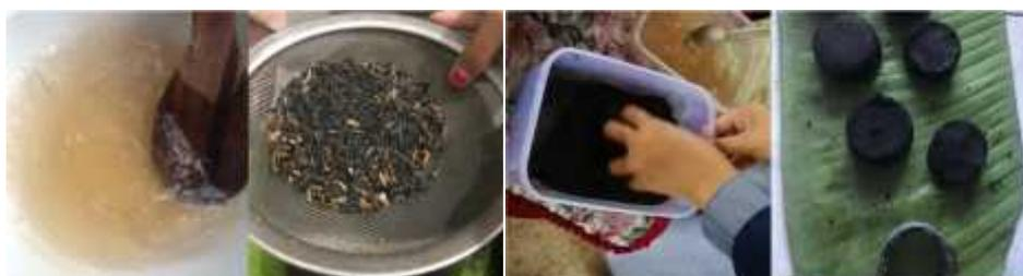
Gambar 2. Proses Pembuatan Briket Arang Sekam Padi
